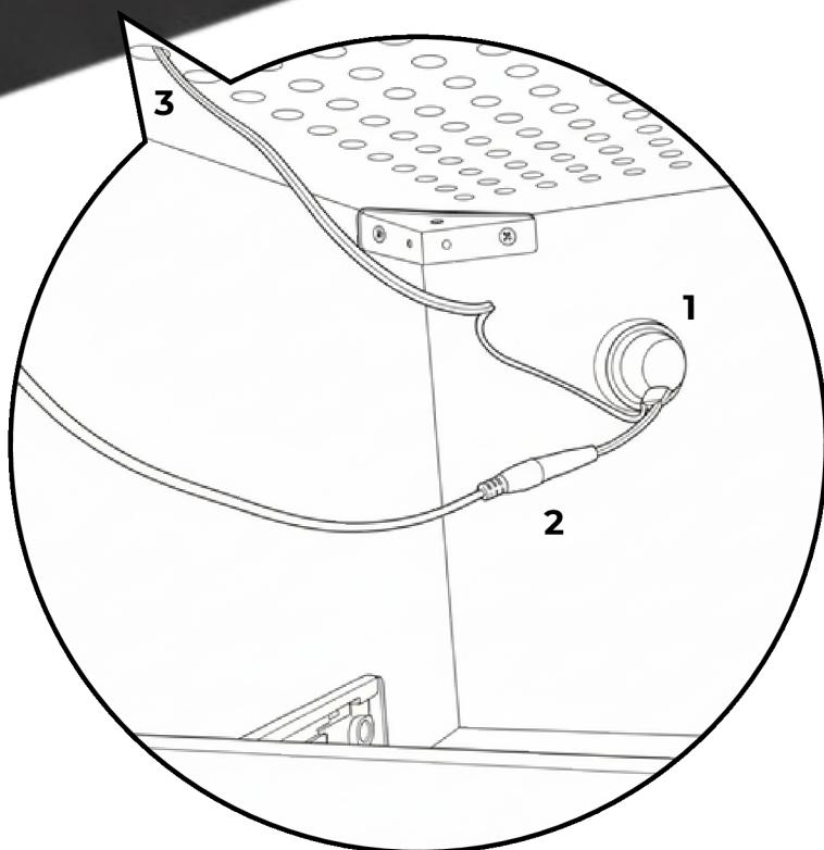
1) HOLE FOR CABLE ENTRY ON BACK PANEL
